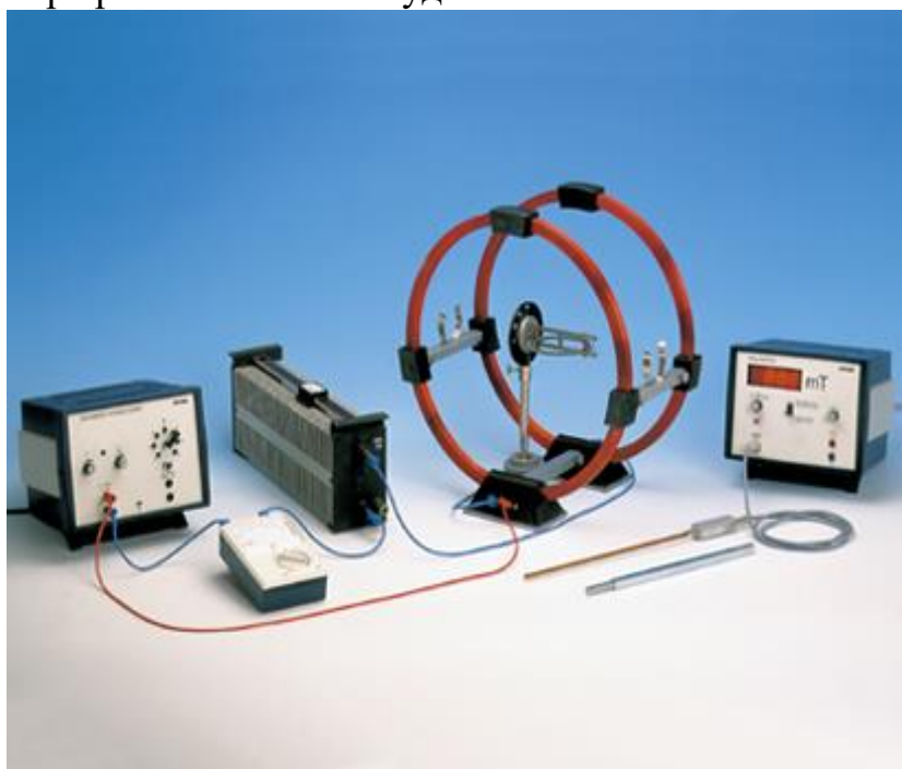
Рис. 20. Установка для измерения составляющих магнитного поля Земли.
