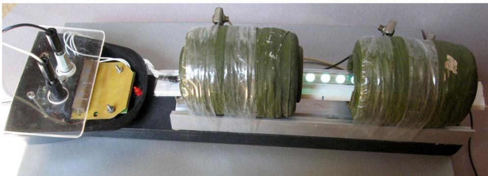
Рис. 8. Лабораторная установка: вакуумно–люминесцентный индикатор в магнитном поле двух катушек.
