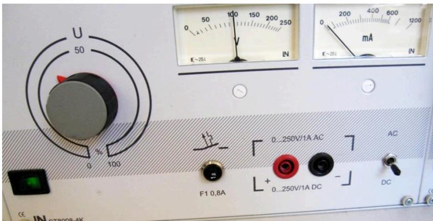
Рис. 11. Источник питания электромагнита.
